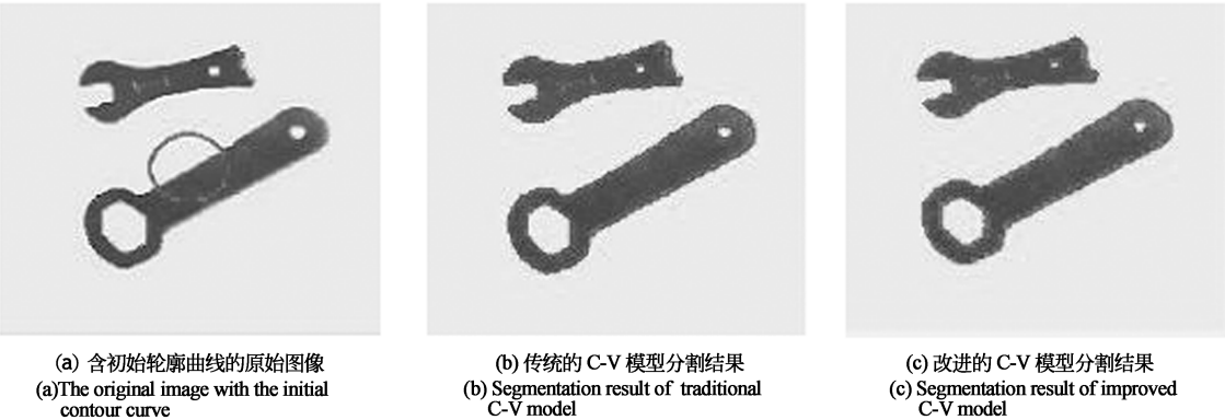
图 5 传统的 C-V 模型与改进的 C-V 模型分割结果对比
